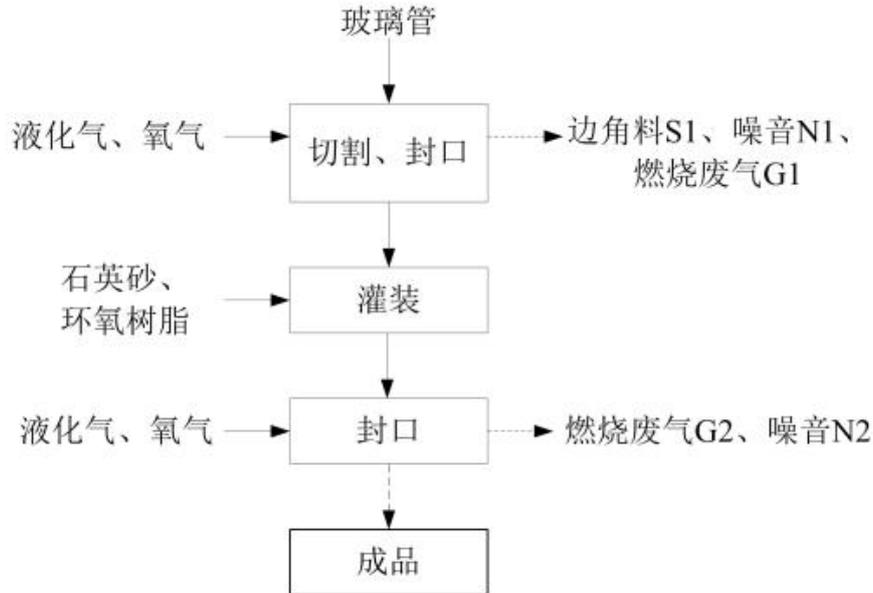
图 3-2 生产工艺流程图
